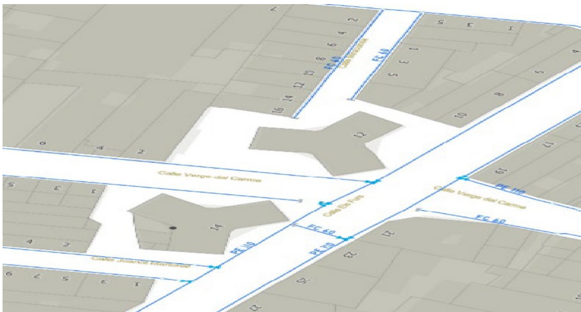
Figura 1. Red de abastecimiento de agua del municipio de Picassent (Intersección entre calle dels Furs y calle Verge del Carme).
