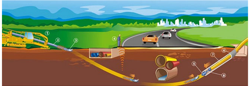
Ilustración 8. Esquema de una Perforación Horizontal Dirigida. (Fuente: Promotor)
